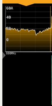
Representação gráfica de sinais de curta duração. Os níveis de sinal são representados no eixo vertical. É uma ótima ferramenta para a análise de sinais de curta duração que seria difícil de observar de outra forma.
