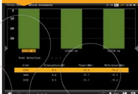
Uma vez activada a entrada de fibra óptica o receptor óptico (selectivo ou não) possibilita medir a atenuação óptica em três comprimentos de onda (1310nm, 1490nm e 1550nm) e respectivas potências, permite analisar também instalações RFOG.
