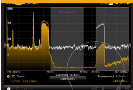
Análise a influência do sinal LTE nos canais TDT, detectando a necessidade de instalação de filtros. Permite simular o espectro de acordo com filtro que o medidor recomenda. Apresentada uma lista de filtros para que o utilizador possa escolher o que melhor se adequa a sua instalação.
