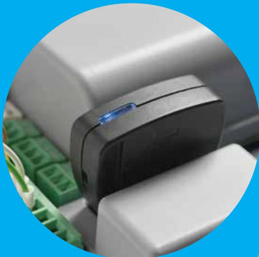
Grazie a CAME KEY e alla App CAME SetUp l'installatore può impostare i parametri dell'automazione tramite smartphone o tablet, direttamente sul posto, senza bisogno di una connessione ad Internet.
