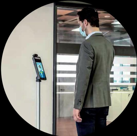
A **Câmara Termográfica** é utilizada para a medição da temperatura do corpo, verificando também se a pessoa está a utilizar uma máscara facial de proteção, combinando estas funcionalidades com o reconhecimento facial. A memória interna do aparelho permite o reconhecimento até 20.000 rostos.
