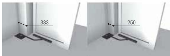
Aplicação enterrada lado maior adjacente ao pilar.
