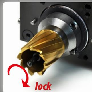
Introduzir a fresa no mandril colocando-a de modo a que o **lado plano** fique alinhado com o **pino transversal roscado** no interior do mandril, **rodando-o a seguir no sentido dos ponteiros do relógio**;
