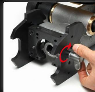
Prender manualmente as duas inserções com as porcas de asas e as anilhas fornecidas no KIT DE ACESSÓRIOS da perfuradora.
