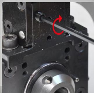
Para proteger o pino transversal roscado, aperte-o firmemente no "orifício de estacionamento" situado no dispositivo de bloqueio para esse fim.
