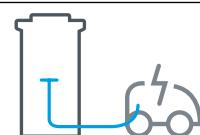
Conexión indirecta del vehículo a la red, a través de cargador externo.
