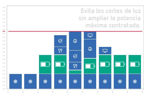
CirBEON, Sensor que ajusta de forma dinámica el consumo del vehículo eléctrico teniendo en cuenta la potencia disponible en la instalación.
