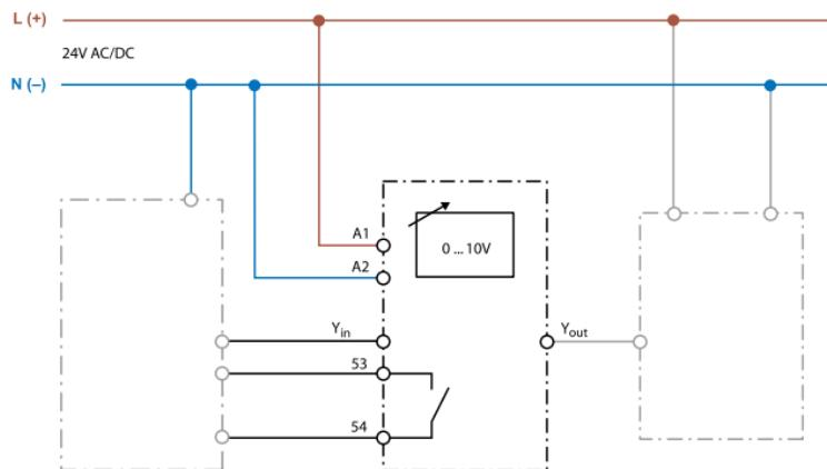
Com o seletor na posição A (Automático) o sinal (0...10)V de Yin - A2 é transferido através de Yout ao equipamento controlado.
