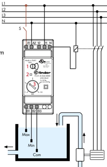
**Esquema de ligação com 2 elétrodos**
