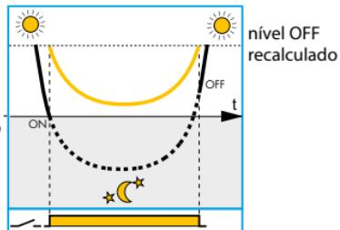
O inovador princípio de compensação da influência da luz artificial controlada evita o acender e o apagar desnecessários das lâmpadas causado pela proximidade do sensor fotoelétrico das lâmpadas por ele controladas
