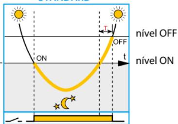
Um relé fotoelétrico normal desliga-se num nível superior ao da ligação, sofrendo, em decorrência disso, um atraso com aumento desnecessário de consumo.
