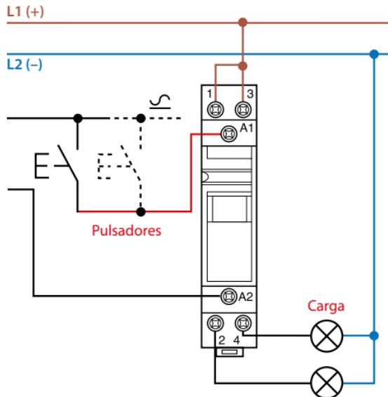
**Tipo 20.2x - Esquema de ligação de comando com alimentação coincidente com a rede e utilização de pulsadores luminosos**
