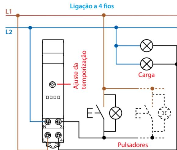
("configuração do botão pulsador" é necessária para a instalação conforme descrita no manual de instalação do produto)
