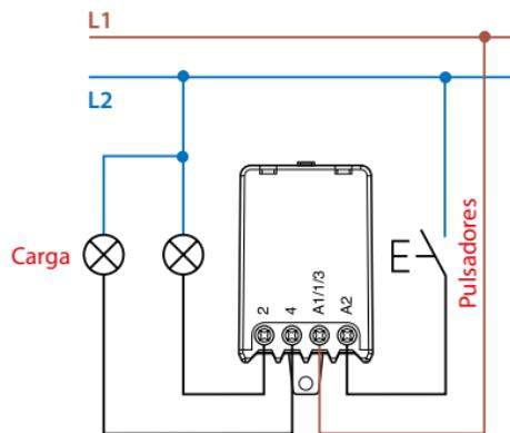
**Esquema de ligação de comando com alimentação coincidente com a rede e utilização de pulsadores luminosos**
