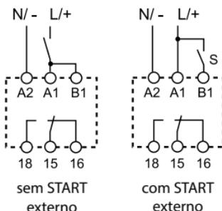
Esquema de ligação com Start coincidente com a alimentação
