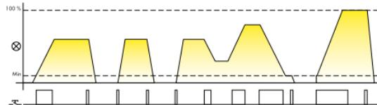
**Comando com impulsos longos:** (através da pressão do pulsador) a luminosidade é aumentada ou diminuída progressivamente.
