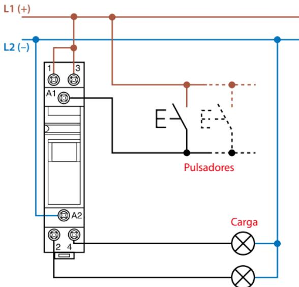
**Tipo 20.2x - Esquema de ligação com comando em baixa tensão**
