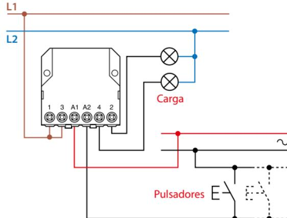
**Tipo 26.0x - Esquema de ligação de comando com alimentação coincidente com a rede e utilização de pulsadores luminosos**
