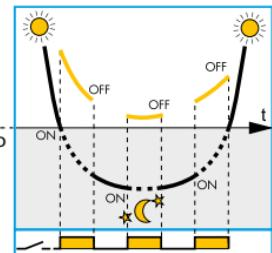
Funcionamento incorreto (ciclo de lâmpadas entre posição ligado e desligado), devido à proximidade do sensor da lâmpada controlada
