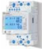
Contador de energia multifuncional bidirecional com display de matriz retroiluminado. Certificado MID a 80 A, 70 °C para sistemas trifásicos com 3 ou 4 fios e sistemas monofásicos.
