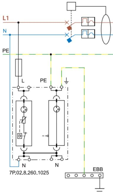
*Exemplos de esquemas de instalação*
