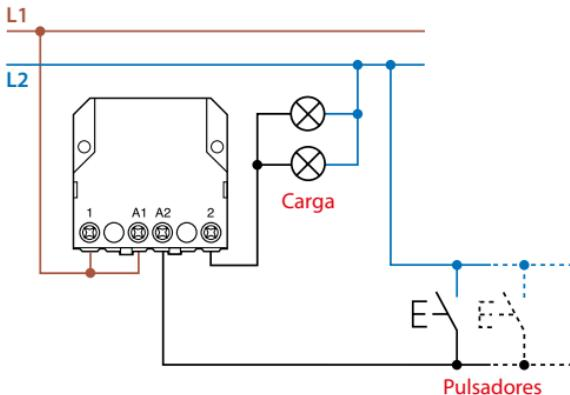
**Tipo 26.01 - Esquema de ligação com comando em baixa tensão AC**
