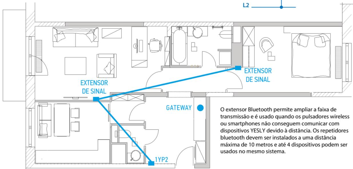
O extensor Bluetooth permite ampliar a faixa de transmissão e é usado quando os pulsadores wireless ou smartphones não conseguem comunicar com dispositivos YESLY devido à distância. Os repetidores bluetooth devem ser instalados a uma distância máxima de 10 metros e até 4 dispositivos podem ser usados no mesmo sistema.
