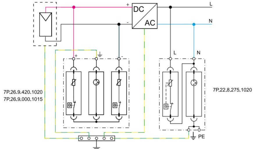
Exemplos de esquemas de instalação
