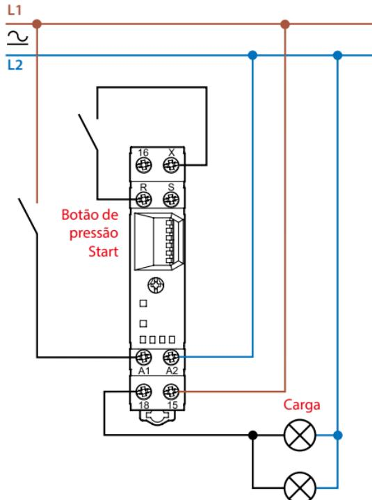
**Tipo 81.01 - Esquema de ligação com Start externo**
