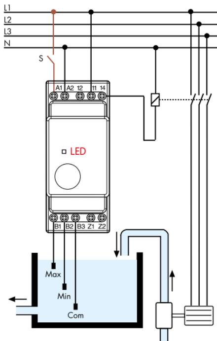
Esquema de ligação com 2 elétrodos
