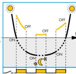
Relé fotoelétrico Tipo 11.41 e 11.91 com compensação da luz artificial da lâmpada
