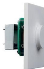
**A. com um amplificador:** São mais compactos e simples. A potência máxima não excede os 400 W RMS, o número de entradas e seu processamento é limitado.
