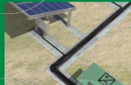
**3** Instalação BT DC entre caixas de ligações e inversores
