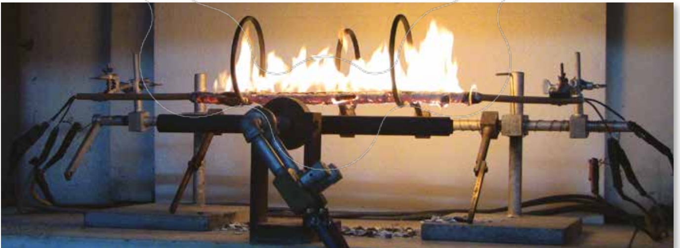
Gerilim altında yanma testindeki bir kablo numunesi.
