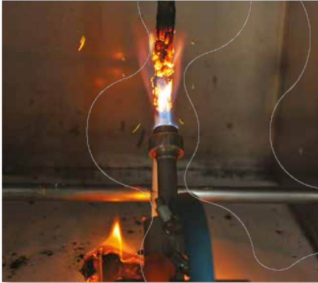
Yanan damlacık testindeki olumsuz bir kablo numunesi.
