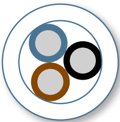
Dış kılıf et kalınlığı için kesit görünümü.
