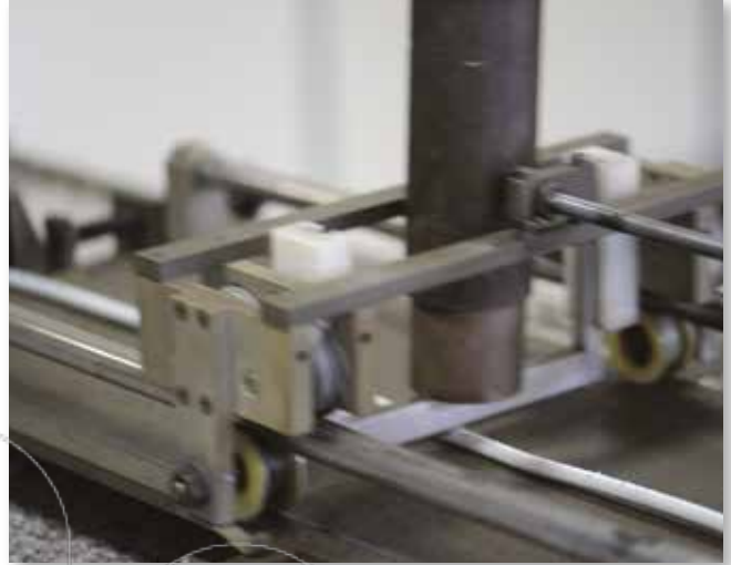
Aşındırma testindeki bir test numunesi.
