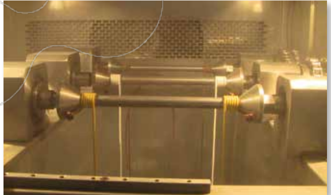
Döngüsel dayanım testindeki kablo numuneleri.
