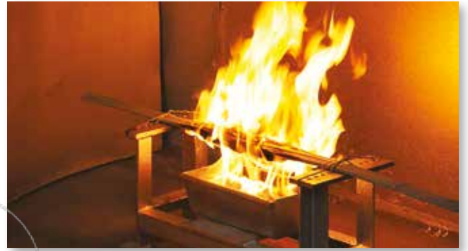
Duman yoğunluğu testinde, yakıt standartlardaki ölçülerde konulmalıdır.
