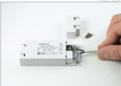
Passo 1: Desparafuse o topo e os cabos do driver
