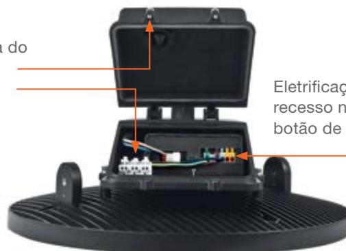
Eletrificação de repicagem simples graças ao recesso na caixa do driver e ao terminal de botão de pressão para dois conjuntos de cabos
