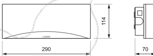
■ **Sistema de conexión pre-placa:** guía el cableado y permite el conexionado eléctrico sin necesidad de abrir o manipular la emergencia, que se coloca simplemente encajándola sobre la pre-placa previamente instalada.
