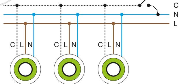
La l3nea de control C permite gobernar el encendido y apagado del LED central en presencia de red (modo permanente o no permanente).
