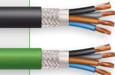
**Construção:** Condutor: Cu classe 5 / Isolação: XLPE / Blindagem: Fita Al/PET + Trança Cu Sn / Bainha: Poliolefina termoplástica, livre de halogéneos (LSZH).
