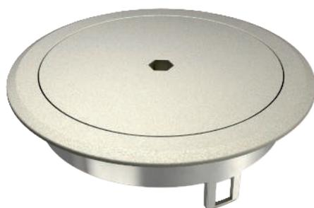
Tampa cega GES R2 com fecho hexagonal no centro para instalação direta no suporte de aparelhos MT R2. Esta versão também pode ser utilizada como saída para cabos, retirando a tampa. No estado fechado, a tampa cumpre o requisito da EN 50085-2-2 para pisos de limpeza com água.
