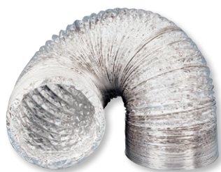
Classificação: M0 Radio de curvatura mínimo: 0,6 \times \varnothing Temperatura de uso: de -30^{\circ}\text{C} a +250^{\circ}\text{C}
