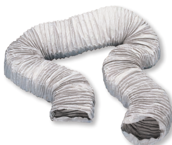
Classificação: M1 Radio de curvatura mínimo: 0,6 \times \varnothing Temperatura de uso: de -30^{\circ}\text{C} a +150^{\circ}\text{C}
