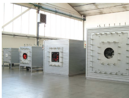
Túneis aerodinâmicos para determinar as prestações caudal-pressão dos ventiladores de níveis sonoros
