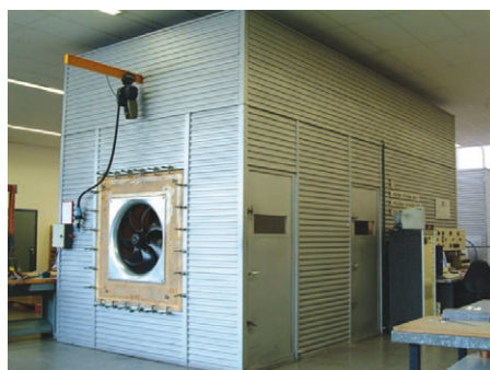
Túneis aerodinâmicos para determinar as prestações caudal-pressão dos ventiladores de níveis sonoros
