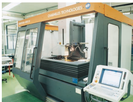
Máquinas de electro-erosão
