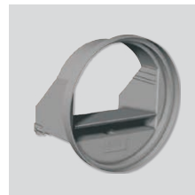
RD BP SM Reguladores de caudal auto-reguláveis. Para instalar no interior no manguito das bocas BDOP. Diâmetro 80 mm. Caudal: 15 ou 30 m³/h.
